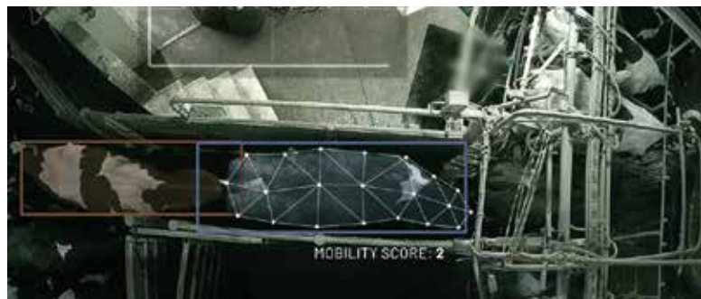
La caméra analyse la locomotion et l'état de chair de l'animal via un algorithme. Gracieuseté : GEA
